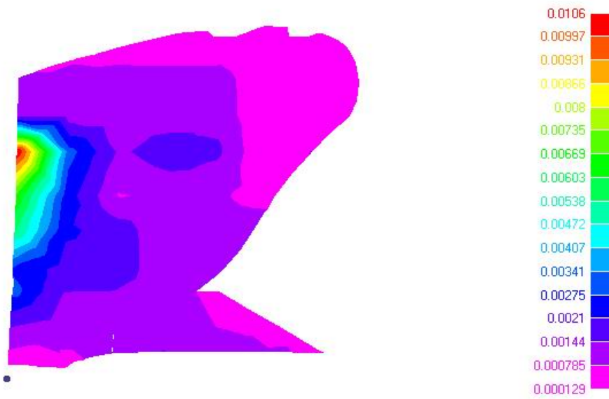
الشكل (5): التوزيع الكنتوري لقيم اعظم إجهاد على بدن المحراث الاعتيادي بالعناصر المحددة ( \text{kg/cm}^2 )
